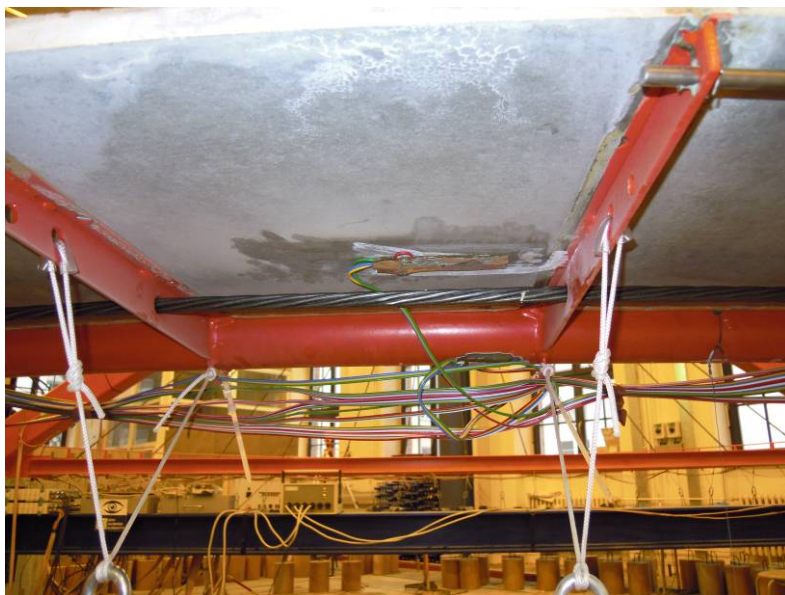
Obr. C.37 Tenzometry na dolním povrchu betonové desky mostovky
