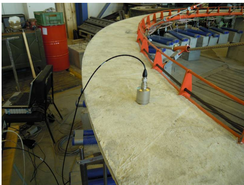
Obr. C.53 Akcelerometr pro měření zrychlení
