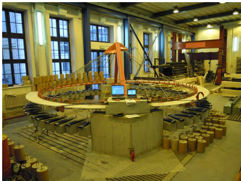
Obr. C.43 Statická zatěžovací zkouška zavěšené části, stav Z-ZSD
