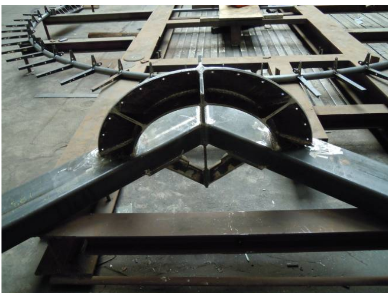
Obr. C.6 Pohled na hlavu pylonu zespod
