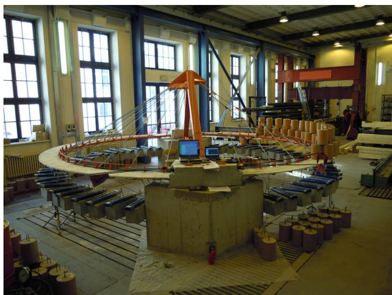
Obr. C.45 Statická zatěžovací zkouška visuté části, stav V-ZSB
