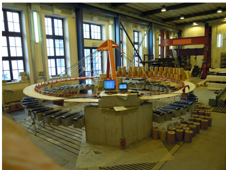
Obr. C.47 Statická zatěžovací zkouška visuté části stav, V-ZSD
