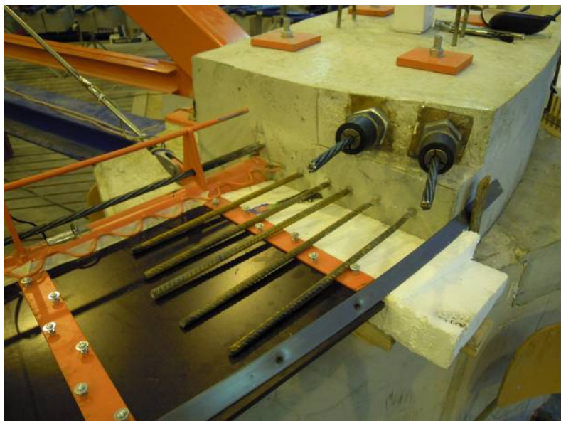
Obr. C.25 Bednění mostovky – řešení náběhu u kotevního bloku
