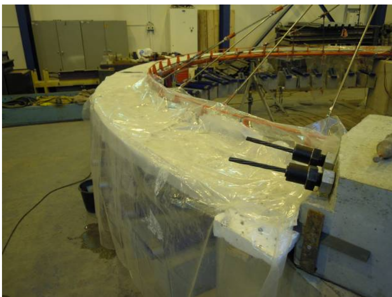
Obr. C.32 Ochrana před vysycháním betonové směsi
