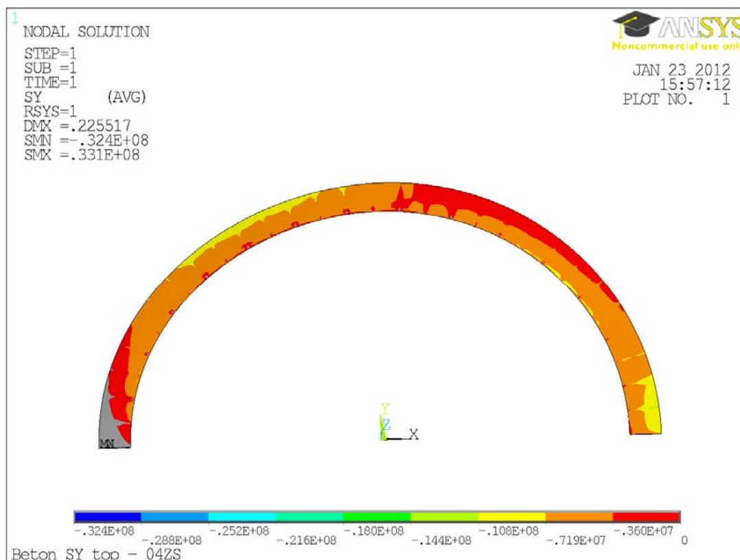
Obr. A.49 Podélné napětí S_x (pouze tlak) – deska – horní povrch – K04
