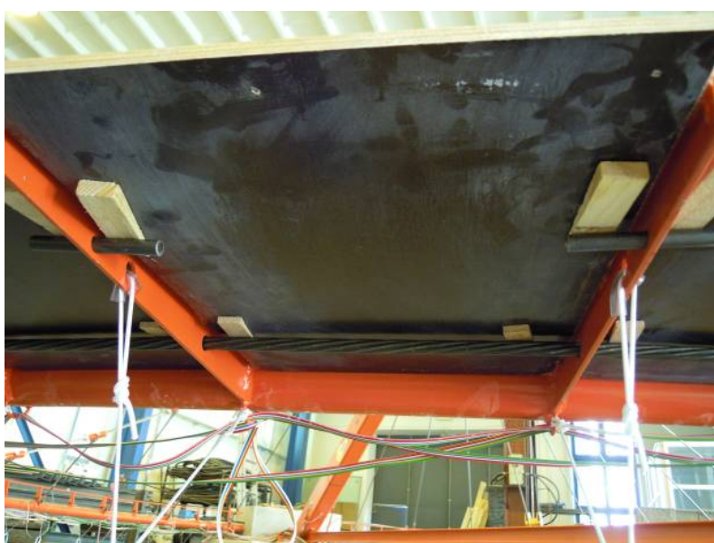
Obr. C.26 Bednění mostovky
