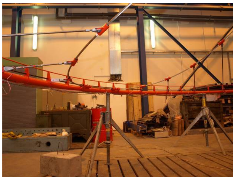
Obr. C.18 Pohled na vidličky a řešení spojení trubky a visutého lana
