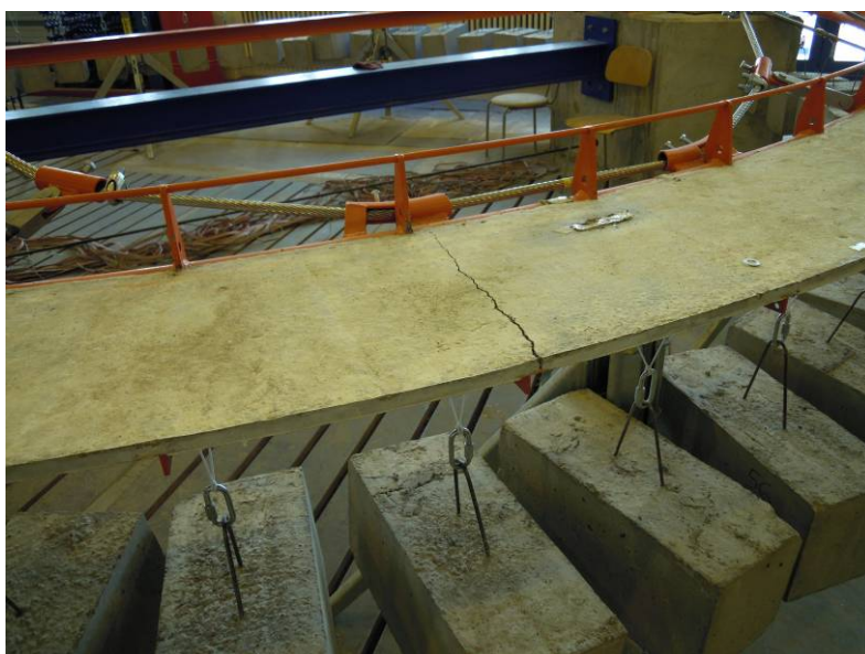
Obr. C.54 Trhlina vzniklá po uvolnění předpětí mostovky
