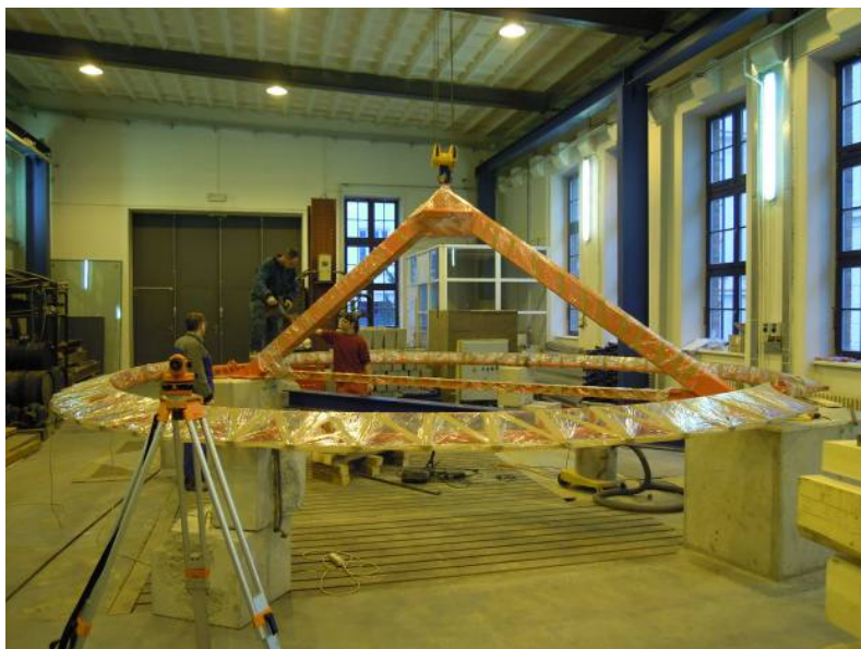
Obr. C.13 Usazení kotevních bloků a ocelové konstrukce
