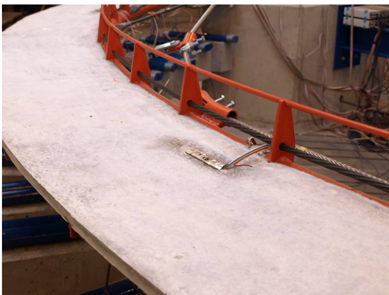
Obr. C.38 Tenzometry na horním povrchu betonové desky mostovky
