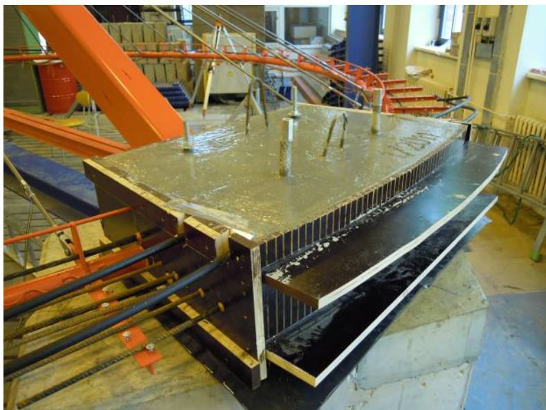
Obr. C.22 Vylitý kotevní blok
