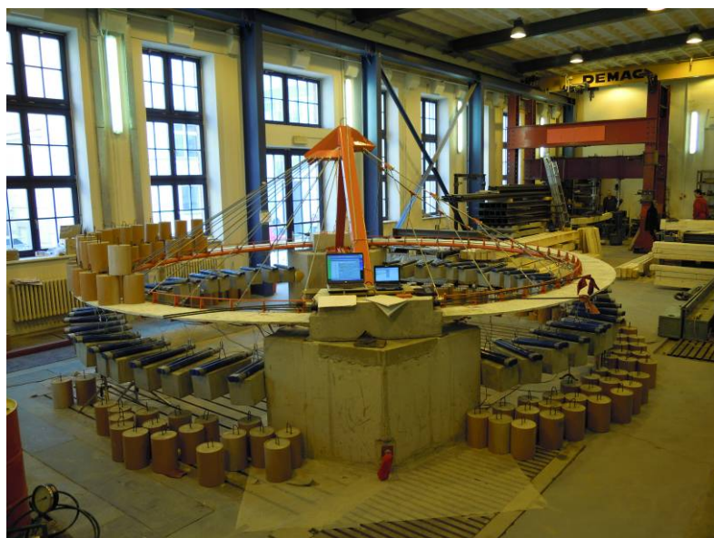
Obr. C.41 Statická zatěžovací zkouška zavěšené části, stav Z-ZSB
