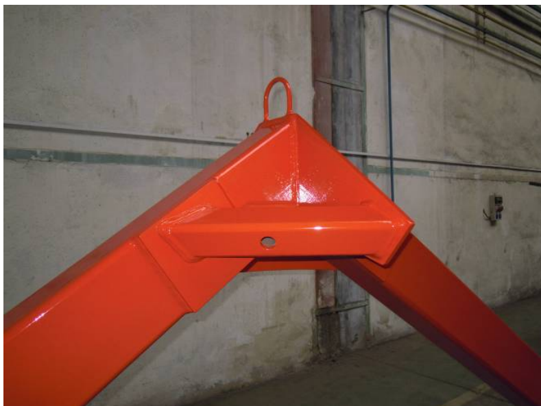
Obr. C.12 Hlava pylonu pro visutou část
