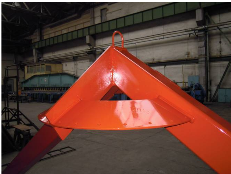
Obr. C.11 Hlava pylonu pro zavěšenou část
