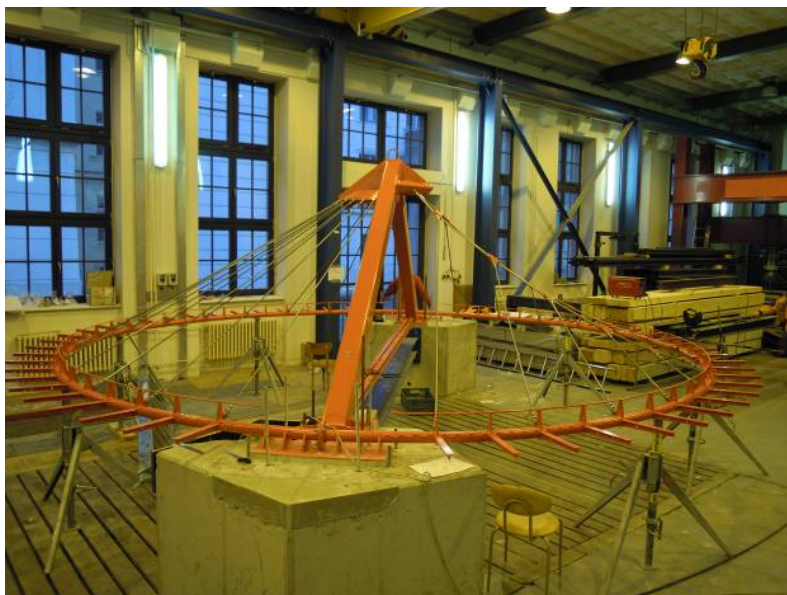
Obr. C.16 Osazení závěsů a visutého lana
