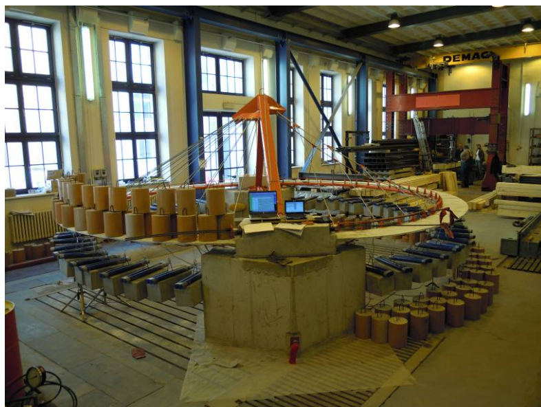
Obr. C.42 Statická zatěžovací zkouška zavěšené části, stav Z-ZSC
