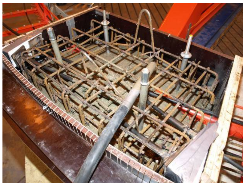
Obr. C.21 Betonáž kotevního bloku.
