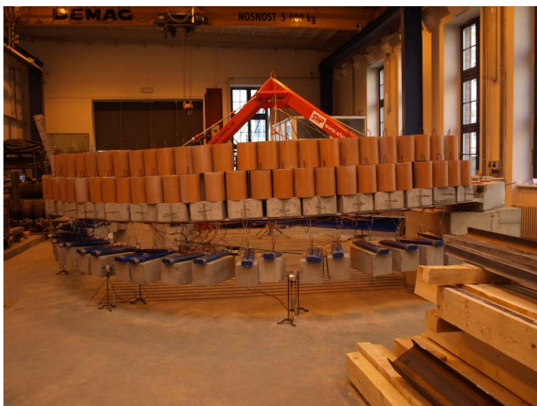
Obr. C.50 Mezní zatěžovací zkouška zavěšené části
