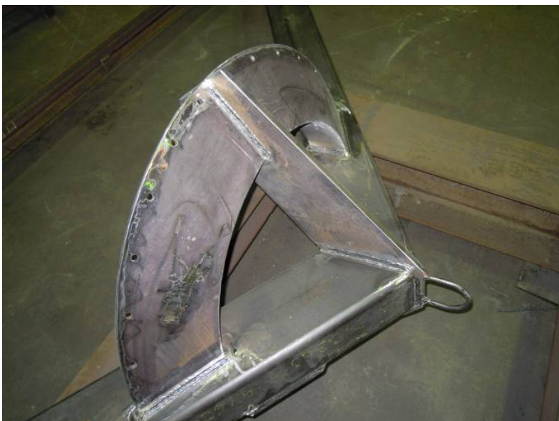
Obr. C.5 Detail hlavy pylonu pro kotvení závěsů
