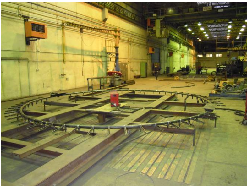
Obr. C.1 Výroba ocelové části mostovky
