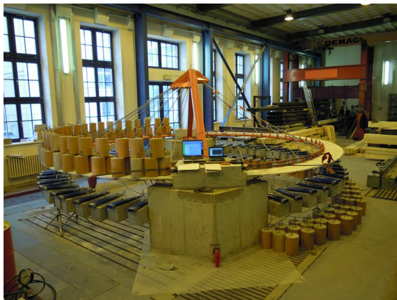
Obr. C.40 Statická zatěžovací zkouška zavěšené části, stav Z-ZSA
