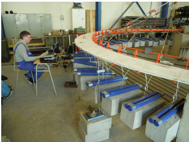
Obr. C.52 Měřicí aparatura pro dynamická měření na modelu
