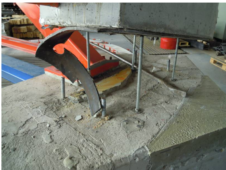
Obr. C.56 Odstranění kotevního bloku pomocí jeřábu
