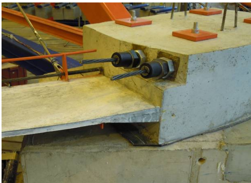
Obr. C.33 Detail náběhu po odbednění mostovky
