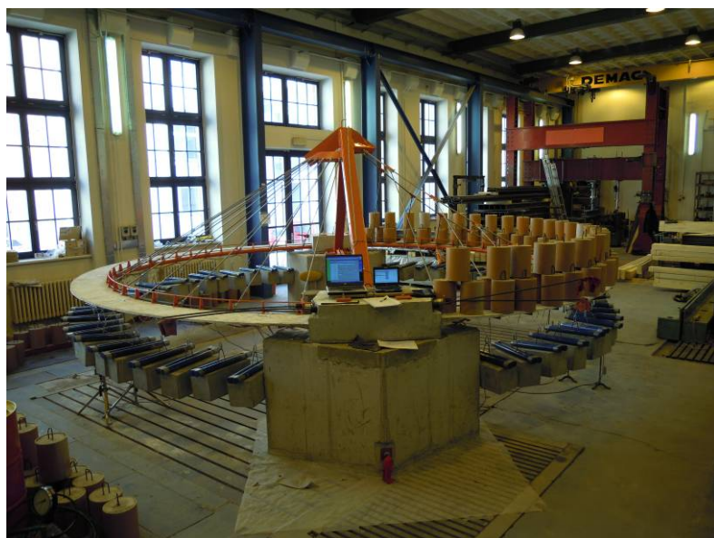
Obr. C.44 Statická zatěžovací zkouška visuté části, stav V-ZSA
