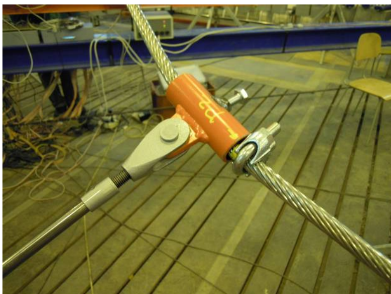
Obr. C.17 Detail spojení visutého lana a závěsů
