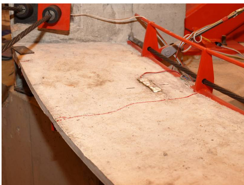
Obr. C.51 Trhliny po mezní zatěžovací zkoušce na visuté části
