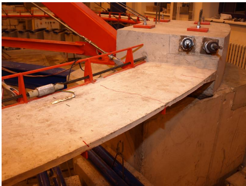
Obr. C.49 Trhliny po mezní zatěžovací zkoušce na zavěšené části
